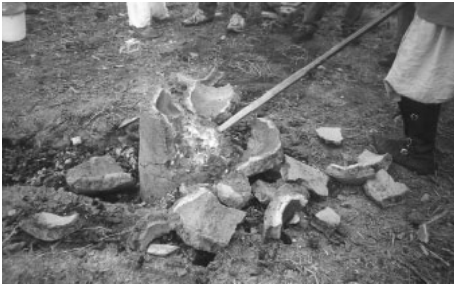
När masugnen krossas ligger den glödande järnmalmen i botten av ugnen.
