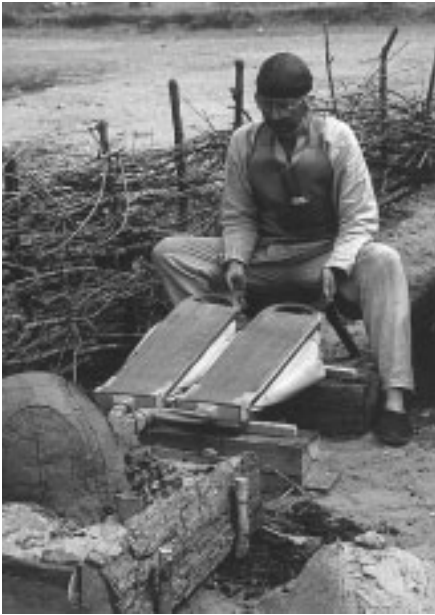
Glaspäretillverkning med bläster och uppbyggd glasugn.
