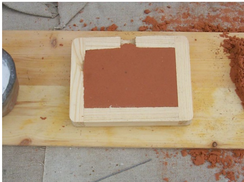
4. Bild på undre delen av ramen, innan modellen ska tryckas in
