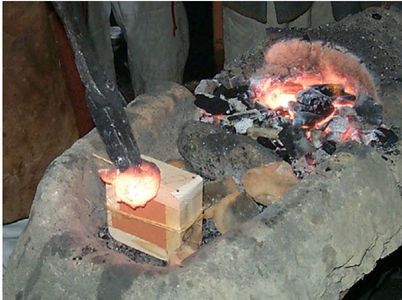
11. Det smälta bronset hålls i gjutformen
