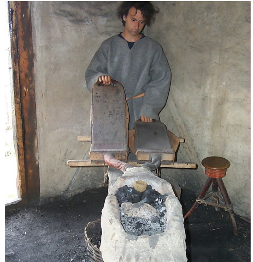
3. Elden hålls levande med hjälp av dubbla blåsbälgar
